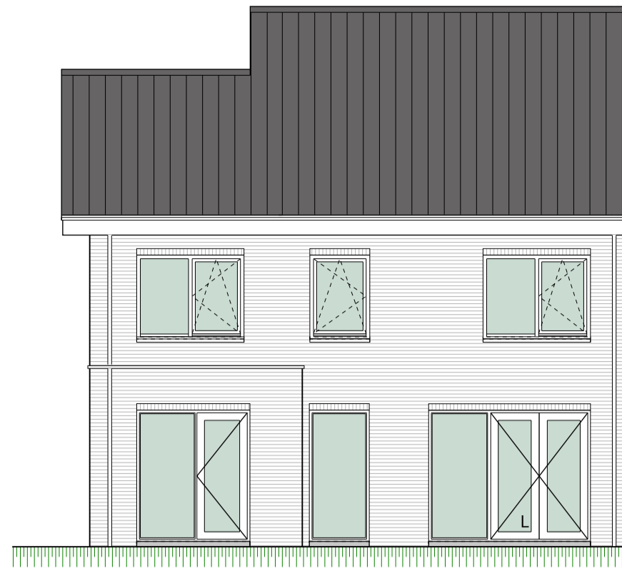
Achtergevel Schaal 1:100 Optie uitbouw garage 2400mm -R.06-
